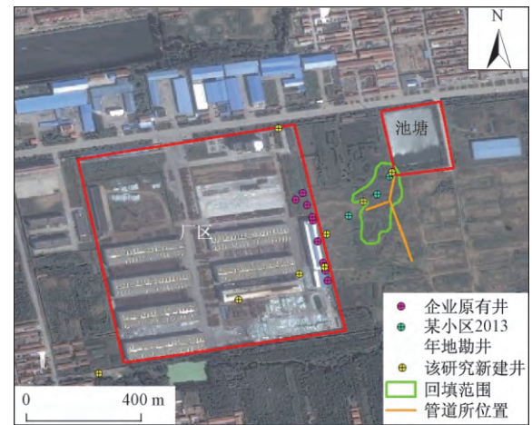
图 6 回填区域和管道埋藏分布
